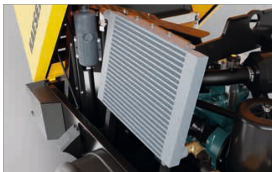
Postenfriador de aire comprimido
